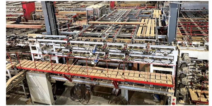
渋滞が解消された製材ライン
